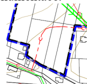
obr.: výřez z výkresu P4 – KVI - VH nad dotčenou oblastí se zakreslením napadené části trasy kanalizačního řádu
