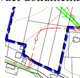
obr.: výřez z výkresu P4 – KVI - VH nad dotčenou oblastí se zakreslením napadené části trasy kanalizačního řadu
